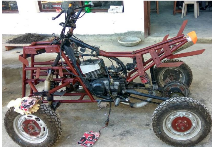
Fig 5: Primer on the chassis
