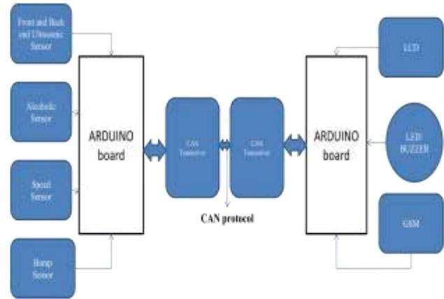
FIG 5. Block Diagram
